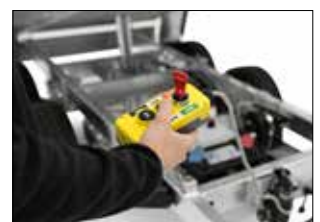
Elektrisch-hydraulische Kippvorrichtung bei Tandem-Modellen
