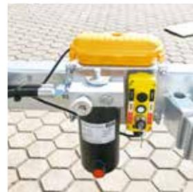
E-Hydraulik mit Notpumpe Pumpless inkl. Steckschlüsseinsatz für einfaches und bequemes Kippen mit dem Akkuschauber z.B. bei schwacher Batterie
