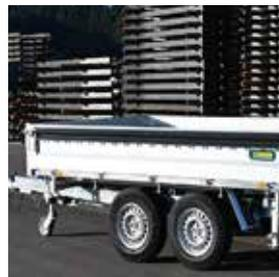
Hohe Anzahl an Bordwand-scharnieren für mehr Stabilität der Stahlbordwand beim Transport von Schüttgütern
