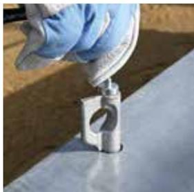
Patentiertes Ladungs-sicherungssystem Spinlock mit Topfmagnet, Zurrpins jeweils mit bis zu 1.500 daN (kg) belastbar, Dekra zertifiziert
