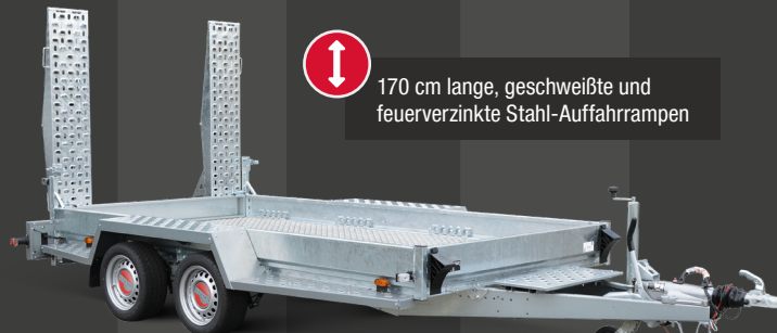
BMAT 02 27-30-14.2 + Trittleche + Schaufelablage + ALU-Riffelblech
